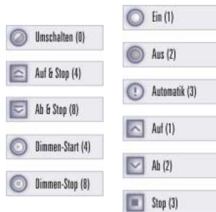
Abbildung 7-10: Z-Bus Einzelbefehle und Zentralbefehle [143]
