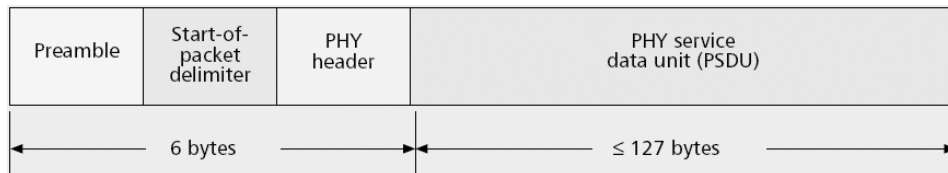
Abbildung 6-6: IEEE 802.15.4 Physical Layer Frame [99]
